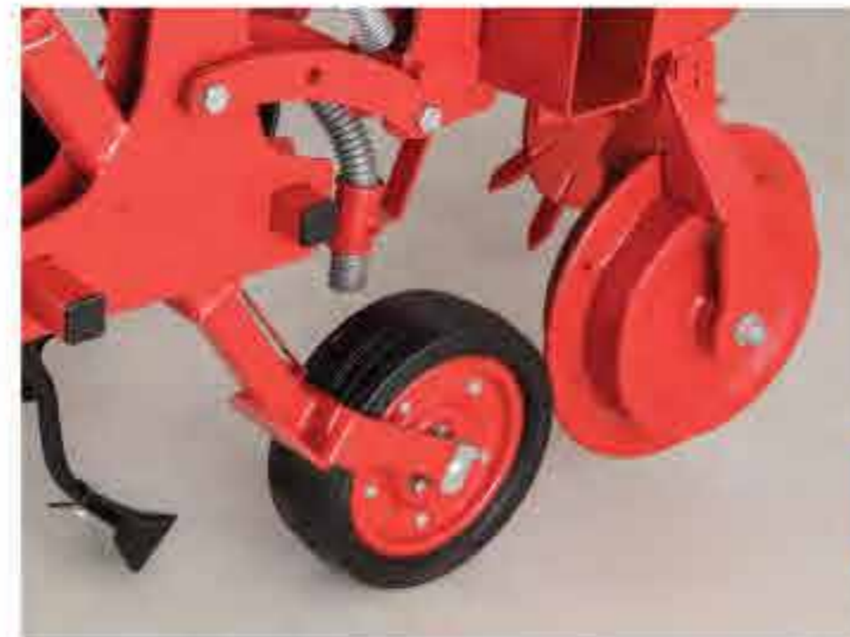
Прижимное колесо Механически регулируемые прижимные колеса позволяют легко регулировать глубину.
