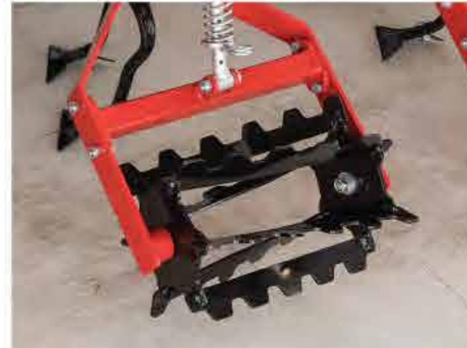
Роликовый сошник Обеспечивает подрезание удаленных сорняков и корректировку междурядий.
