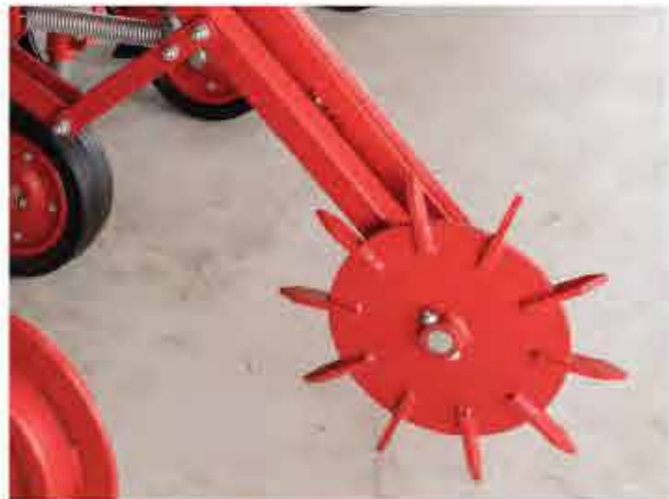
Приводное колесо Превосходная работа редуктора обеспечивается ведущим колесом с цапфами.
