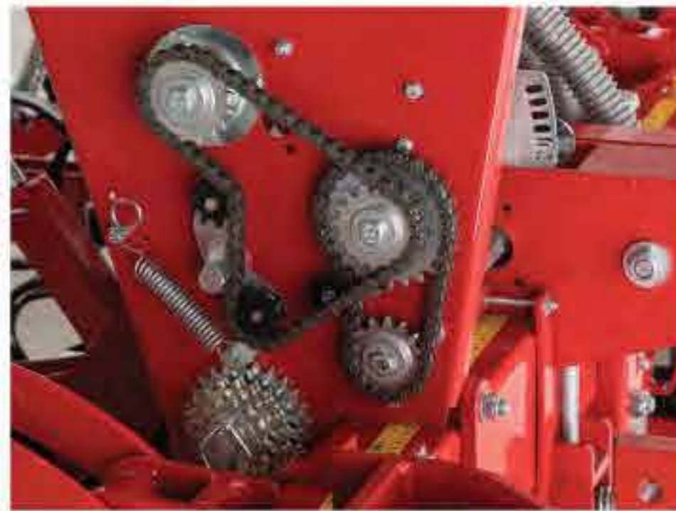
Коробка передач для удобрения Позволяет идеально регулировать количество удобрений, необходимое растению.
