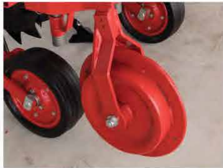
Направляющее колесо Металлические направляющие колеса с регулировкой глубины позволяют легко следить за рядом.
