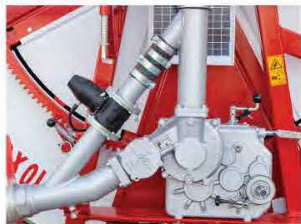
Трансмиссия и электронный байпас Вращение барабана и намотка шланга осуществляется посредством коробки передач, а постоянная скорость намотки контролируется системы байпаса.
