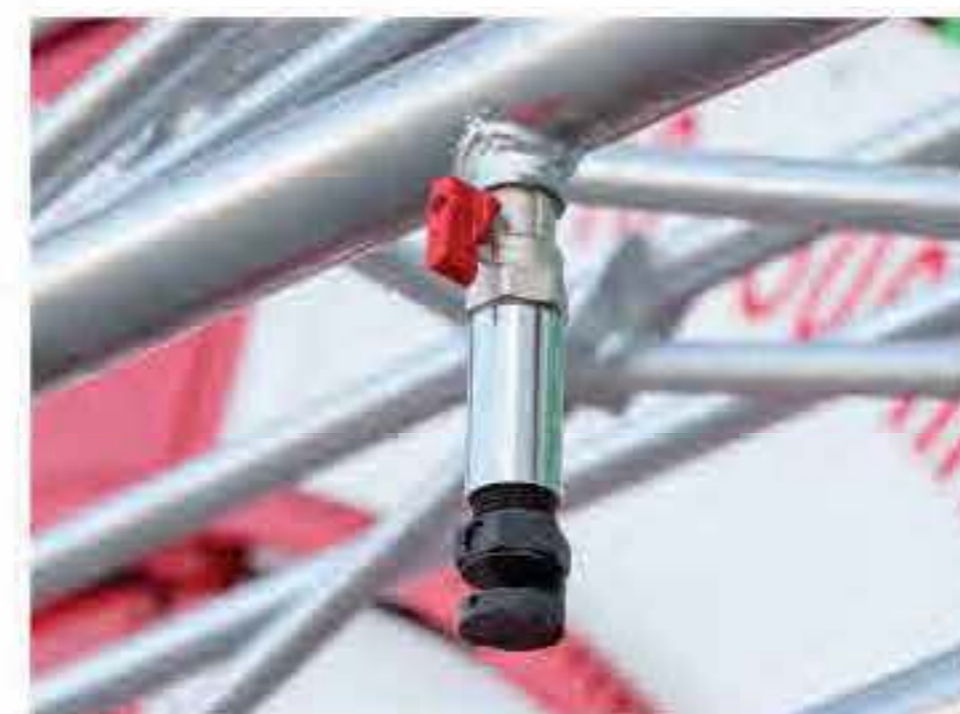
Форсунки В зависимости от типа орошаемого растения и количества подаваемой воды можно использовать форсунки с различными диаметрами отверстий.
