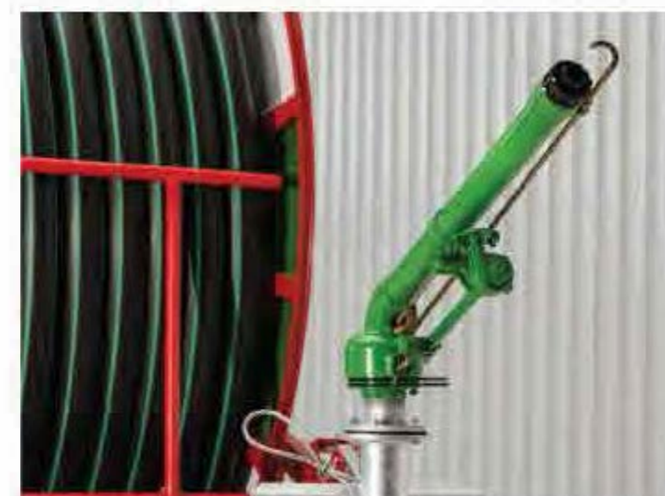
Оросительный спринклер Ороситель, поставляемый вместе или отдельно, является идеальным решением, особенно для высоких растений
