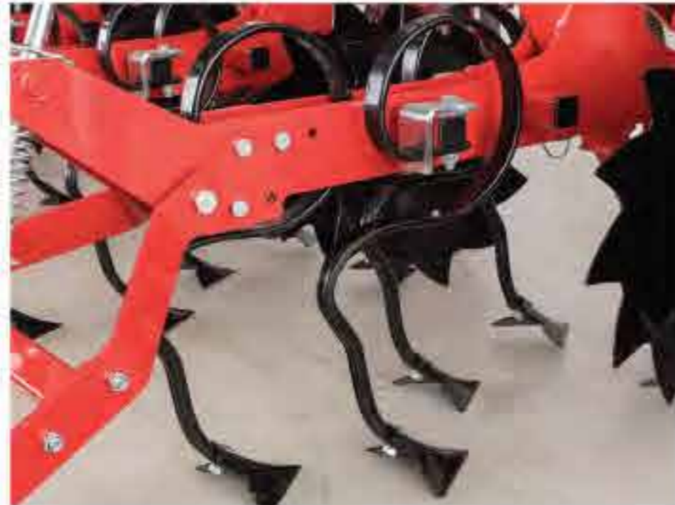
Плоскорезные лапы Очистка почвы и удаление сорняков производится зачистными сошниками.
